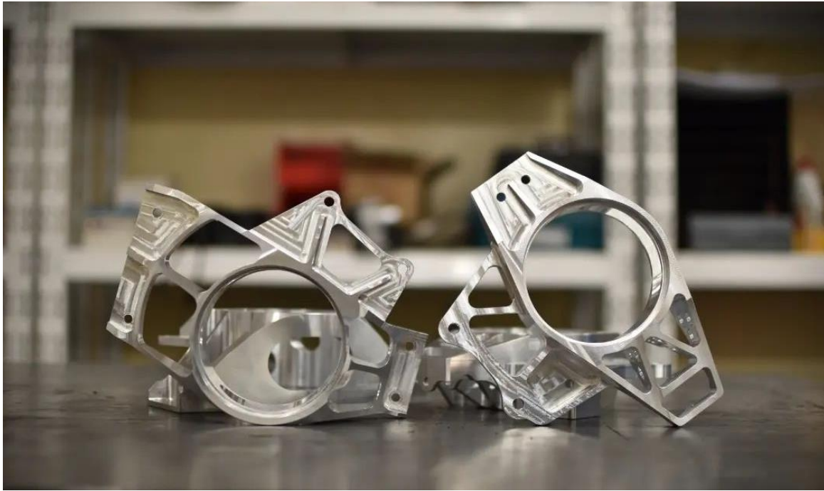
Obr. 15 Těhlice pro čtvrtou formuli týmu FS TUL Racing
