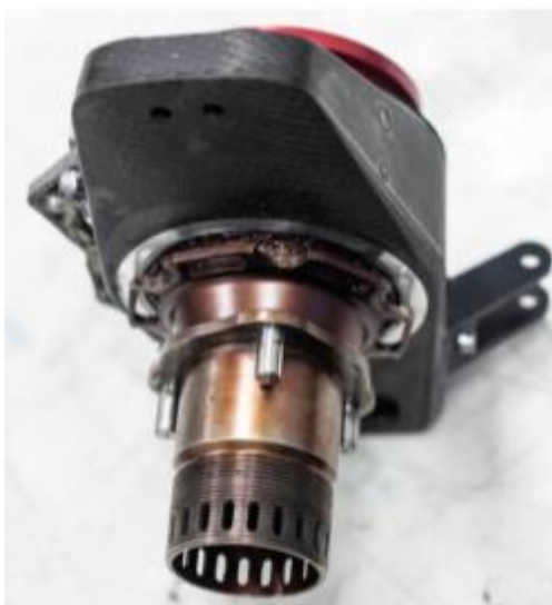
Obr. 11 Kompozitní těhlice TU Gratz [13]
