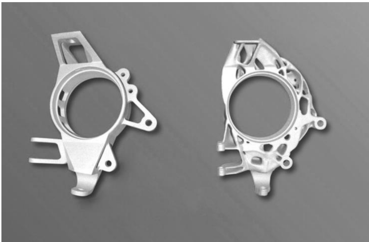
Obr. 57 Porovnání konvenčně obráběné těhlice a lité těhlice [20]
