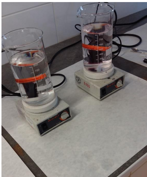
Obrázek č. 7: Snímek zachycující dialýzu koloidů nanostříbra.
