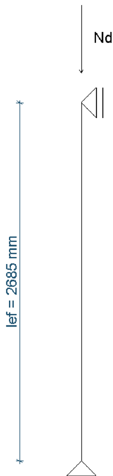
Obrázek 30 Statický model posuzovaného sloupu
