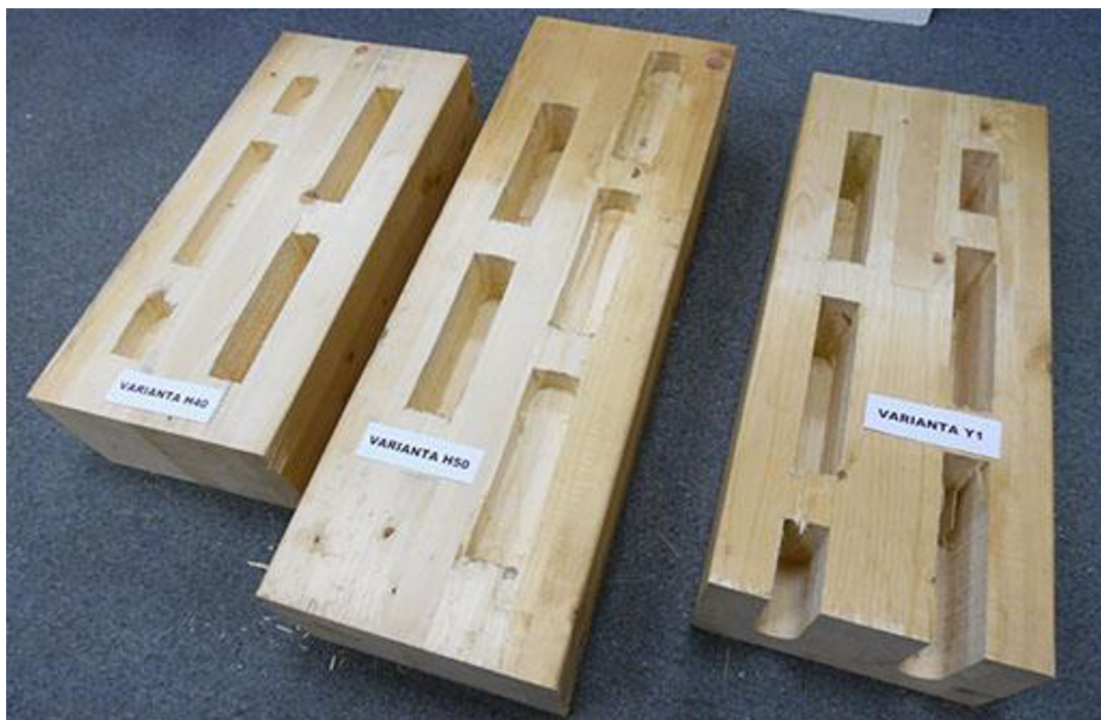
Obrázek 11 BSH roubení s vyfrézovanými drážkami [11]
