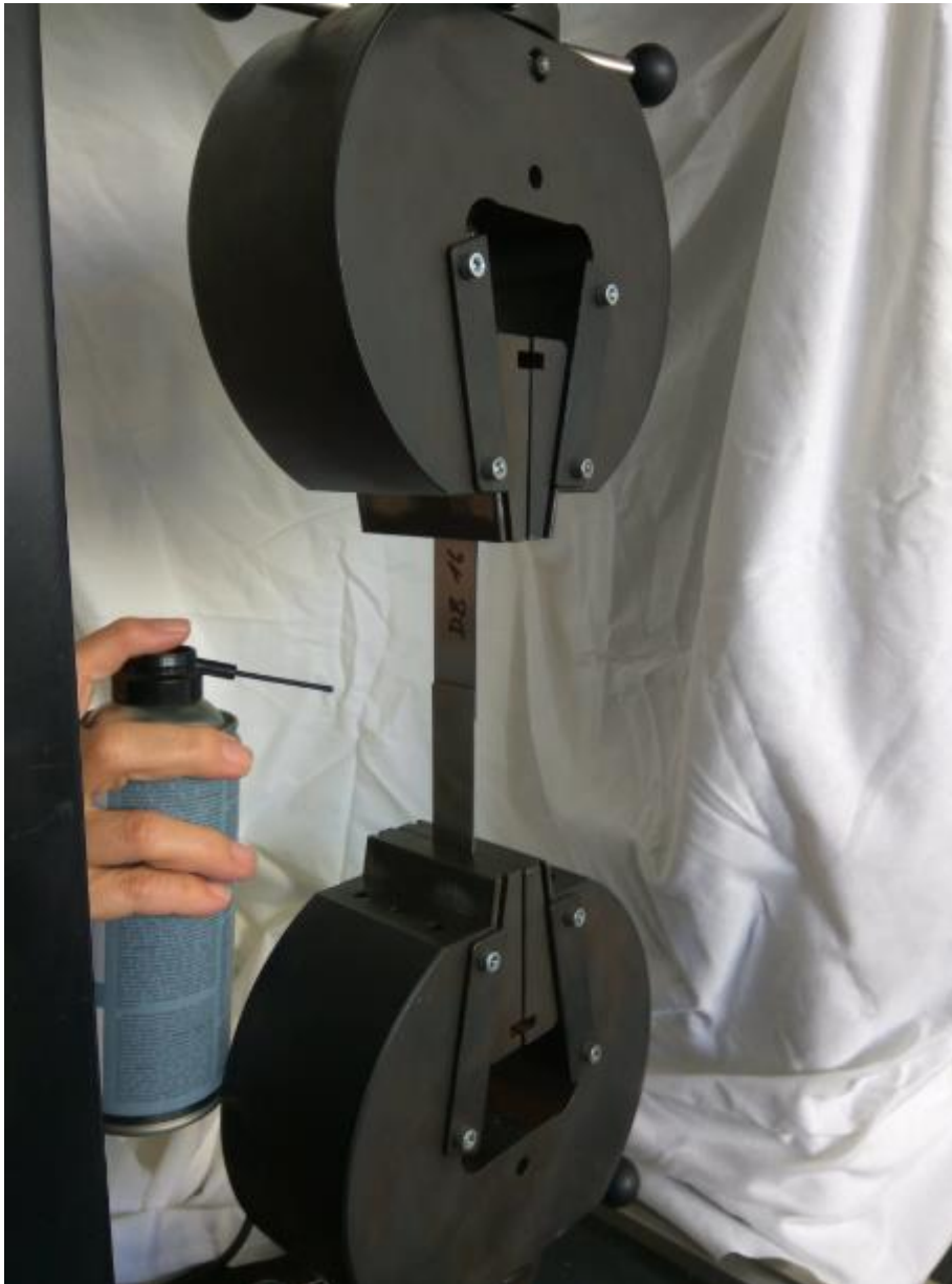
Obr. 18 Princip podchlazování vzorků pomocí chladícího spreje [28]
