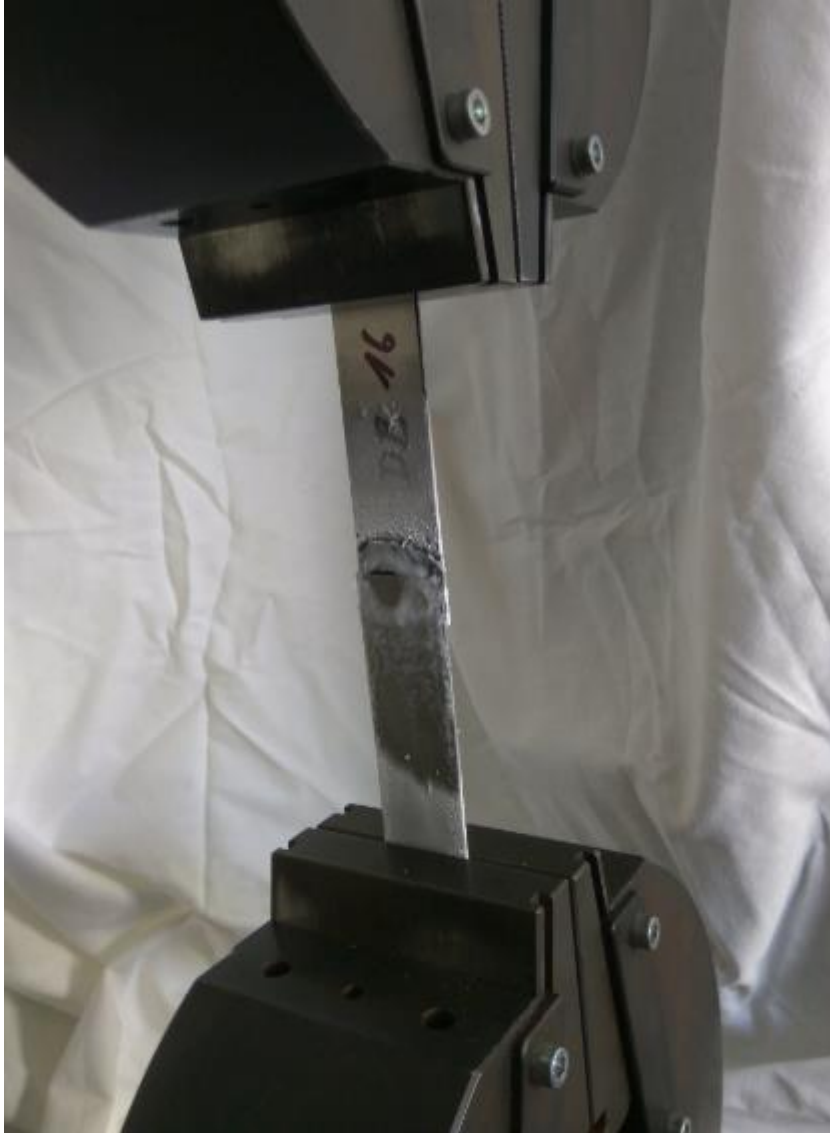
Obr. 19 Podchlazený vzorek v čelistech univerzálního zkušebního stroje [28]
