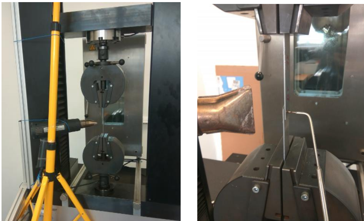
Obr. 17 Způsob ohřívání vzorků pomocí horkovzdušné pistole [28]
