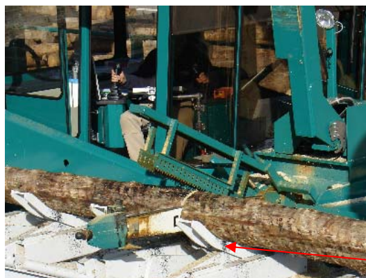
Obr. 15 Nadzvižení a krácení dlouhé kulatiny na výřezy řetězovou pilou třídícího vozíku na manipulačním stole
