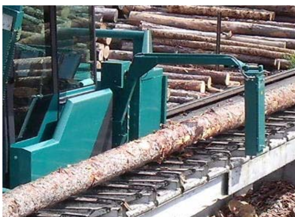
Obr. 13 Měřící zařízení na boku třídícího vozíku měřící kulatinu na manipulačním stole
