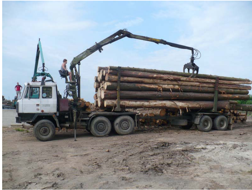
Obr. 10 Vykládka vstupní suroviny hydraulickou rukou nákladního automobilu
