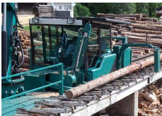
Obr. 15 Nadzvižení a krácení dlouhé kulatiny na výřezy řetězovou pilou třídícího vozíku na manipulačním stole
