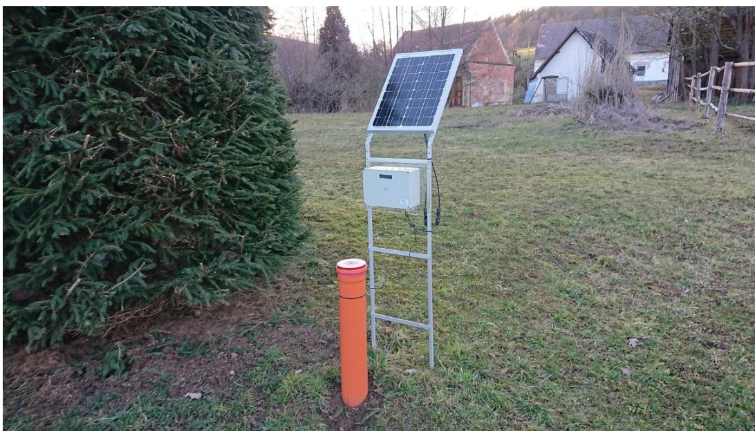
Obrázek 60, Měření výšky hladiny vody v půdní nivě v Kaničkách
