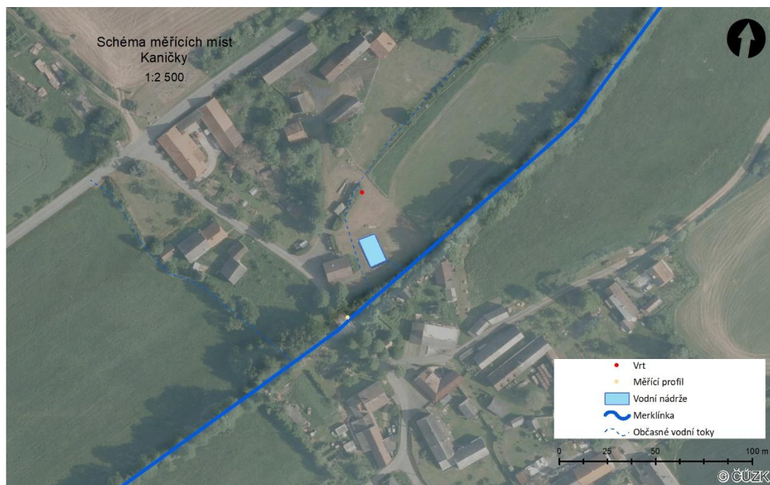
Obrázek 59, Schéma měřicích míst v Kaničkách
