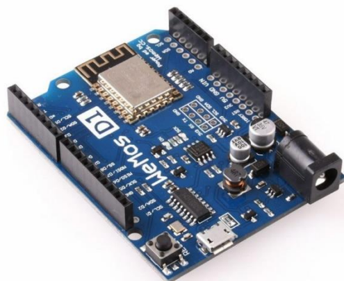
Obrázek 76, Arduino WeMos D1 R1
