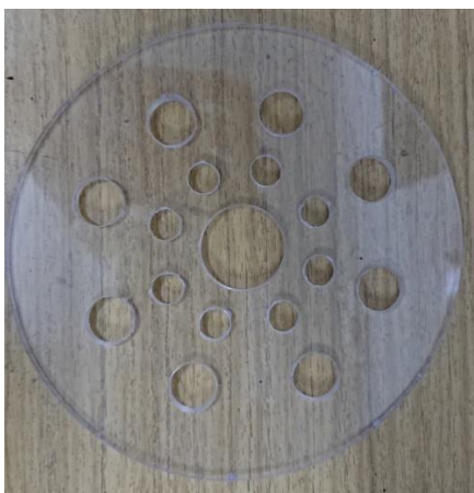
Obrázek 67, Držák ultrazvukové sondy v trubce půdní sondy
