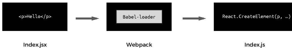
Obrázek 4.1: Webpack používá loaders pro překlad souborů do čistého javascriptu předtím, než je sváže do výstupního souboru.
