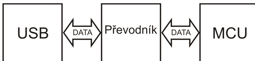
Obrázek 16 - Schéma převodu USB/MCU
