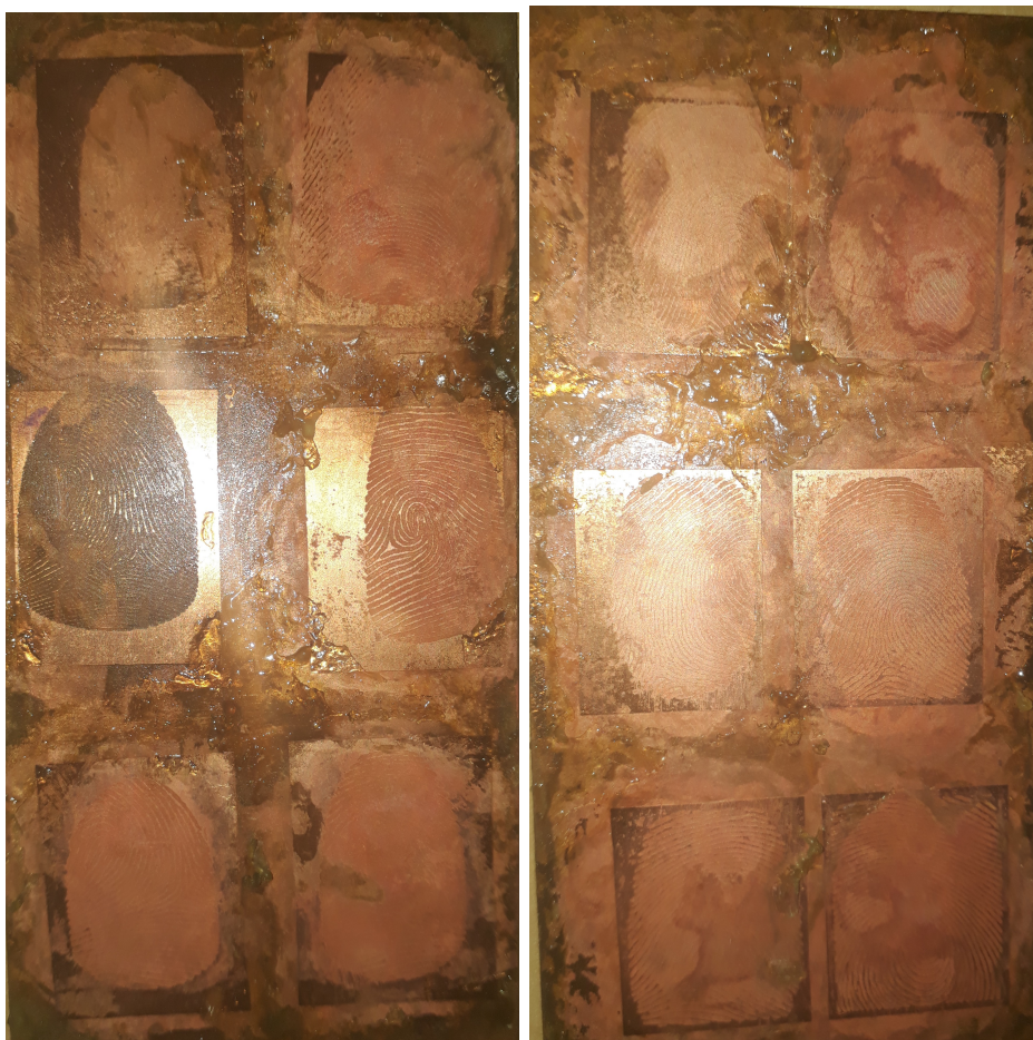
Obrázek 6.3: Formy vytvořené metodou leptání. Vlevo syntetické otisky, vpravo reálné.
