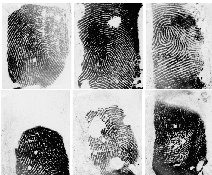
Obrázek 6.5: Příklady snímků vzniklých z falzifikátů. Nahoře jsou povedené snímky, dole nepovedené.
