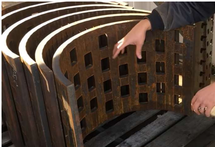
Obr. 18: Výměnná síta kladivových drtičů [19]
