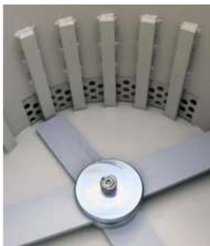
Obr. 24: Drtící lopatky bubnového drtiče [28]
