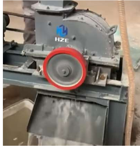
Obr. 20: Omezení prašnosti drcením s přívodem vody [23]
