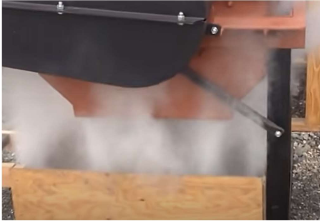
Obr. 19: Ukázka prašnosti při jemném drcení [22]
