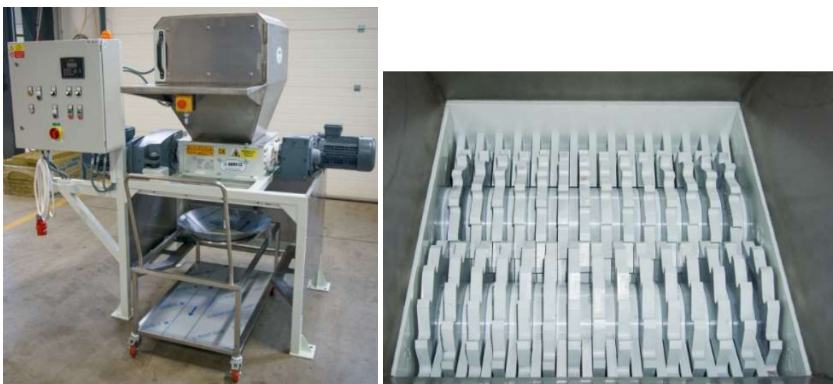
Obr. 13: Malý dvouhřídelový drtič se dvěma pohony (vlevo stroj, vpravo drtící ústrojí) [15]
