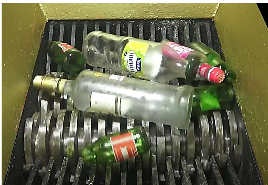
Obr. 15: Ukázka problému s velkým průměrem drceného materiálu [16]
