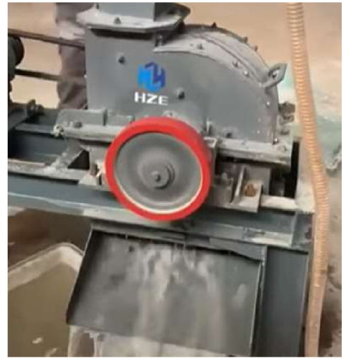
Obr. 20: Omezení prašnosti drcením s přívodem vody [23]
