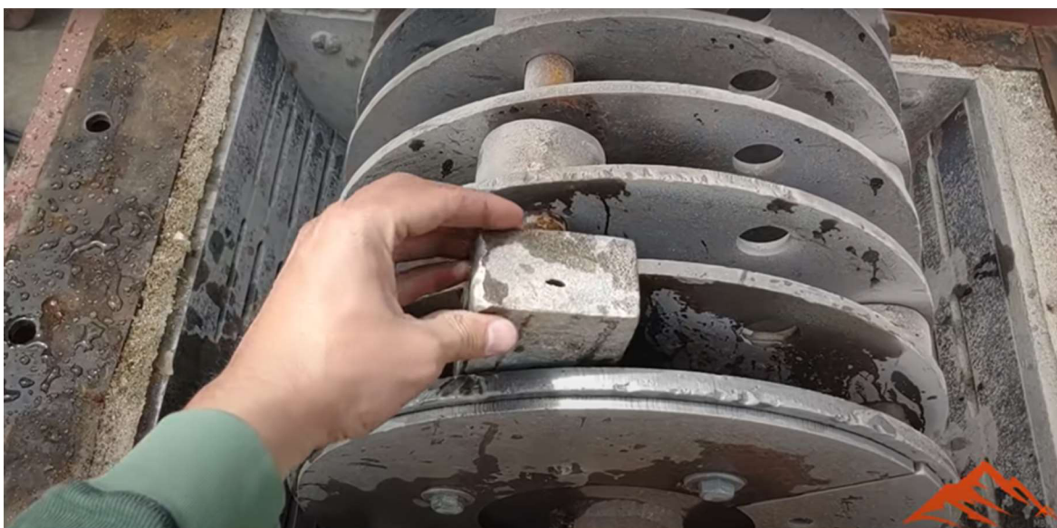
Obr. 17: Ukázka rotoru, síta a šachovnicového uspořádání kladiv v kladivovém drtiči [20]
