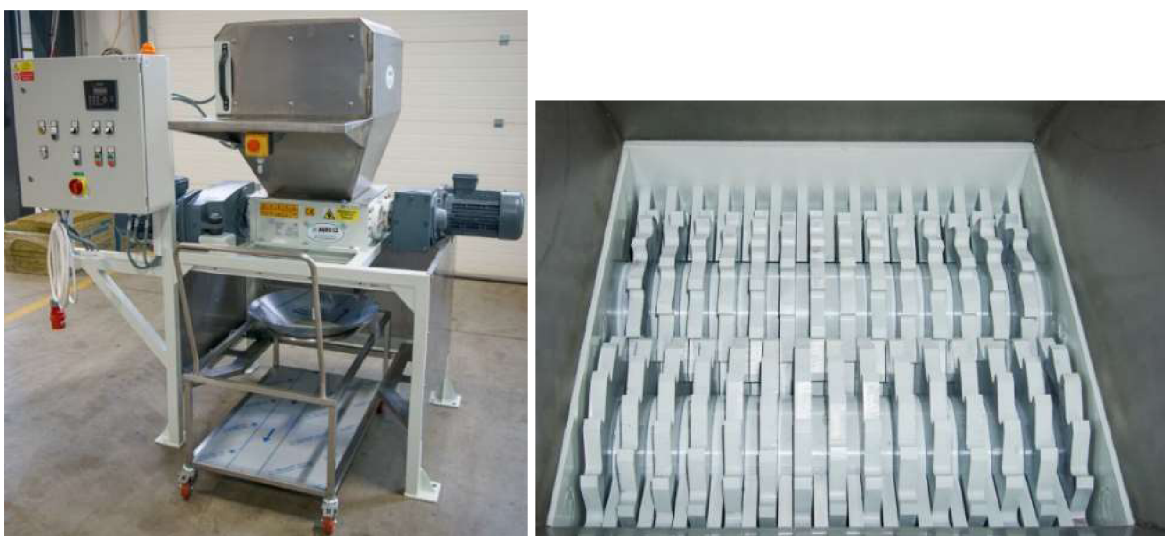
Obr. 13: Malý dvouhřídelový drtič se dvěma pohony (vlevo stroj, vpravo drtící ústrojí) [15]
