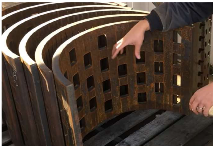
Obr. 18: Výměnná síta kladivových drtičů [19]
