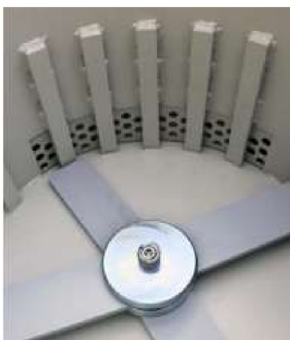
Obr. 24: Drtící lopatky bubnového drtiče [28]
