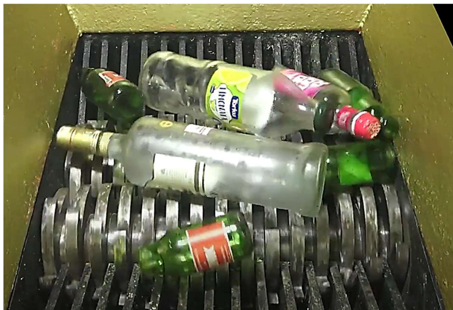
Obr. 15: Ukázka problému s velkým průměrem drceného materiálu [16]
