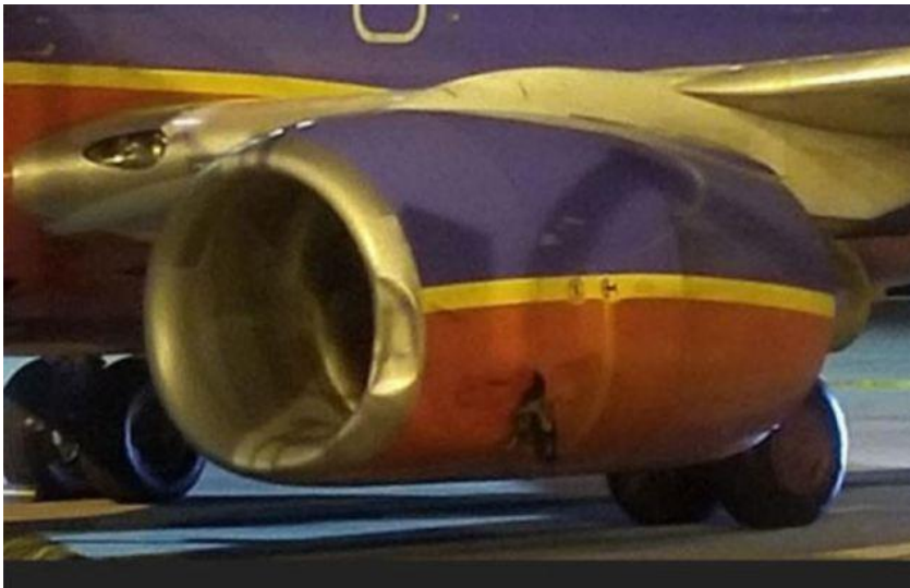
Obrázek 31 Poškození motoru letadla po kolizi s osobou 52
