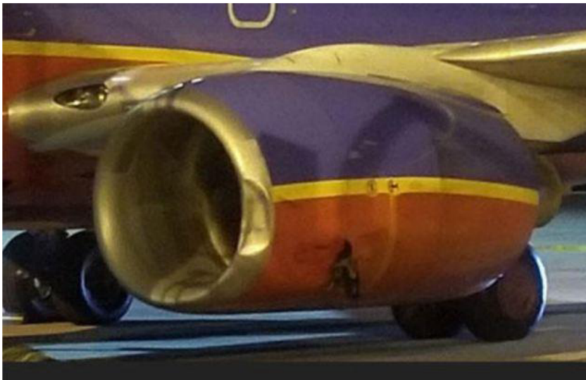
Obrázek 31 Poškození motoru letadla po kolizi s osobou 52
