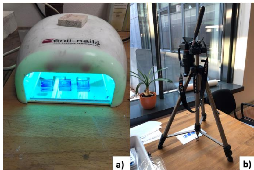
Obr. 19: a) Osvícení vzorku pomocí UV lampy, b) Aparatura sestavená na focení sklíček po osvitu.
