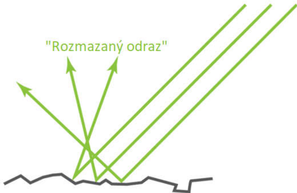
Obr. 27 Schéma odrazu svetla od bežných materiálov
