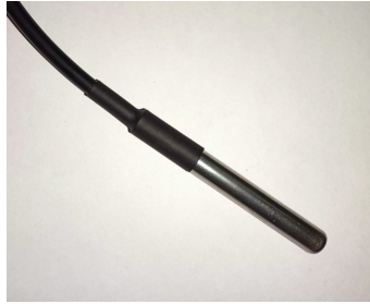
Obr. 2.4: Snímač teploty DS18B20
