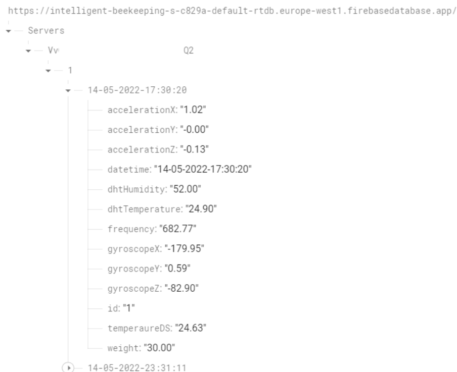
Obr. 4.5: Uložená data v databázi a jejich struktura ukládání
