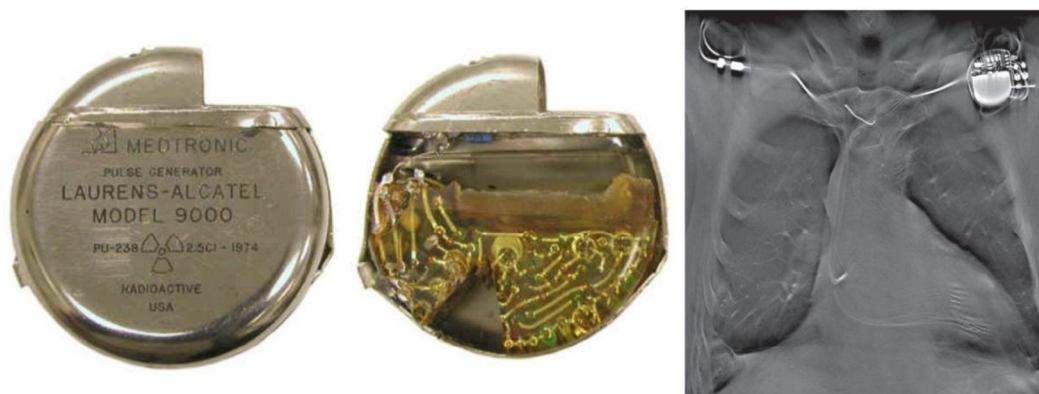
Obr. 3.2: Plutoniový kardiostimulátor s rentgenovým snímkem po implantaci, převzato z [50].
