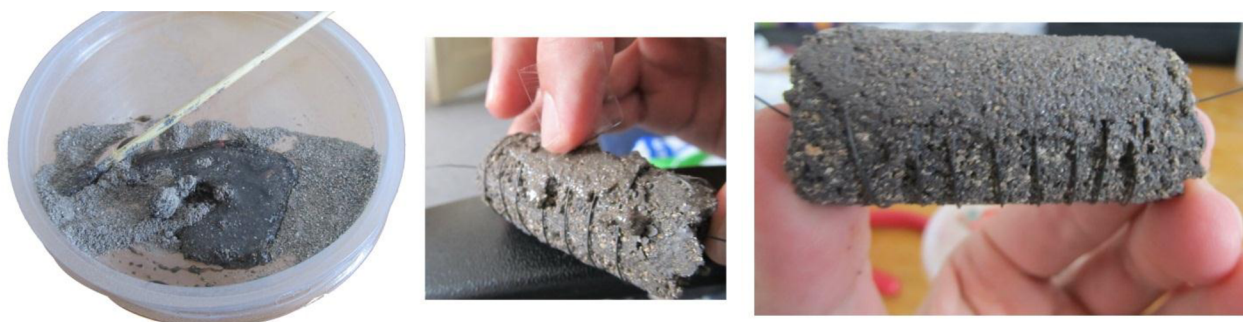
Obr. 6.5: Nanесení izolační vrstvy o tloušťce cca 2 mm.
