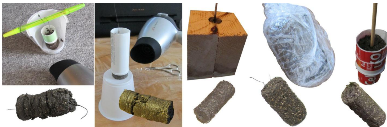
Obr. 6.3: Jednotlivé technologie výroby topného článku s výsledným produktem.
