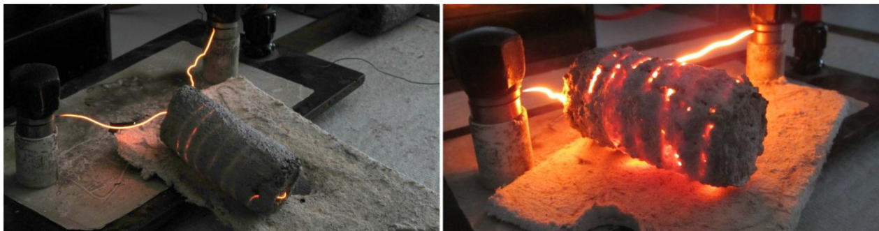
Obr. 6.8: Trovba trhlín při technologii potírání a obalování.
