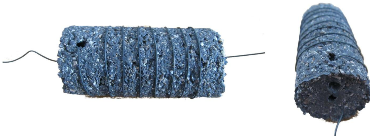
Obr. 6.4: Způsob navinutí odporového drátu na vysušenou konstrukci.
