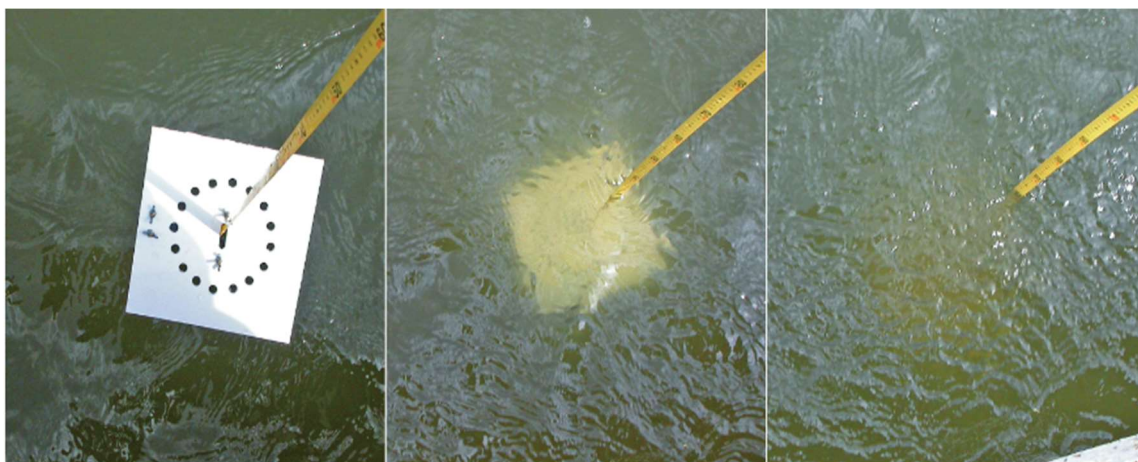
Obr. 3.2 Měření průhlednosti pomocí Secchiho desky [19]
