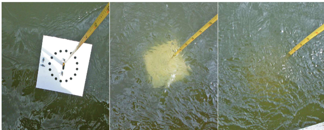
Obr. 3.2 Měření průhlednosti pomocí Secchiho desky [19]
