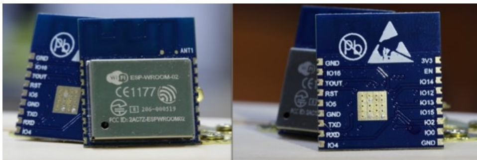
Obr. 2.1: WROOM-02 (převzato z [19]).
