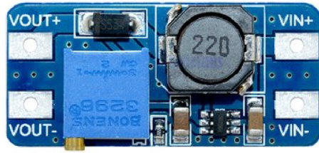
Obr. 3.5: Napěťový měnič s integrovaným obvodem MT3608.
