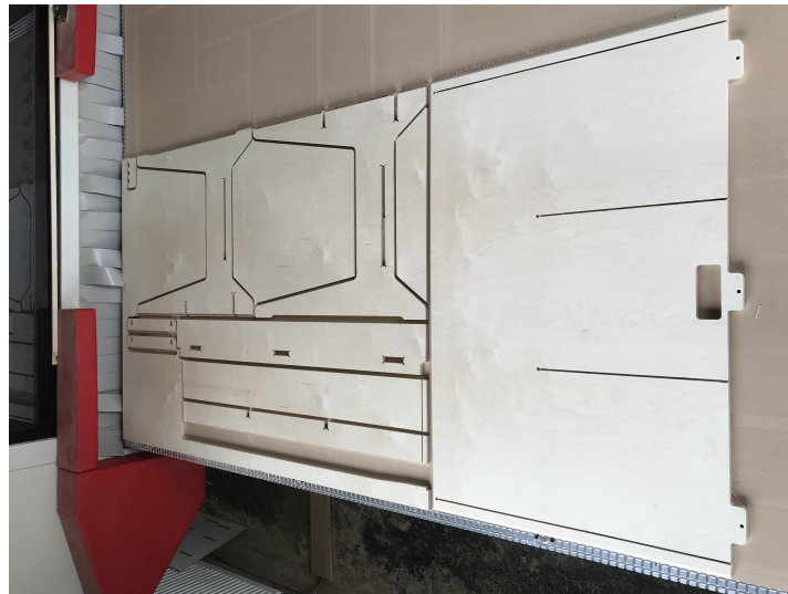
Obr. 20. - obrobená deska březového multiplexu na CNC zařízení Pratix – S
