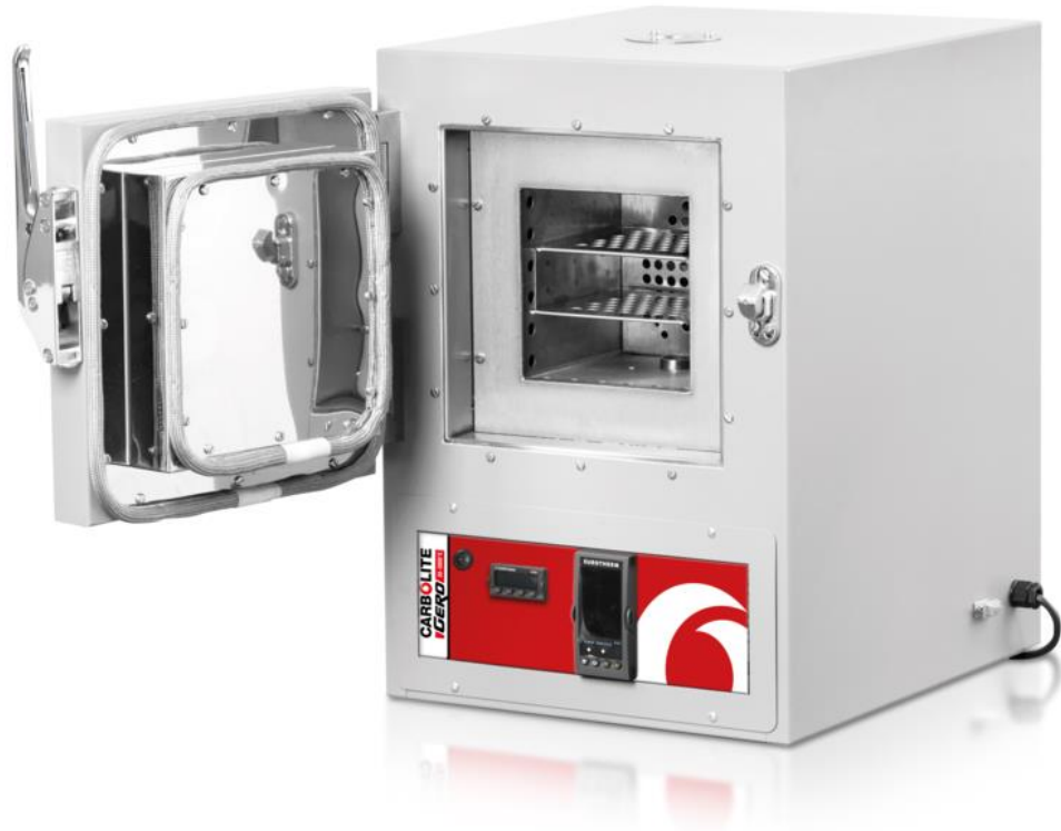
Obrázek 9: Pec pro vypékání TLD dozimetrů, zdroj: (TLD Pece,2018)
