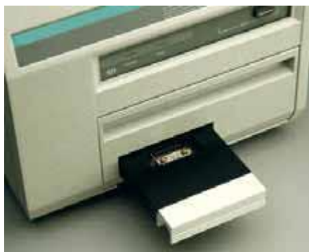
Obrázek 5: Planžeta přístroje Harshaw 3500, zdroj:vlastní
