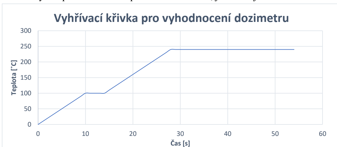
Obrázek 11: Vyhřívací křivka pro vyhodnocení dozimetru
