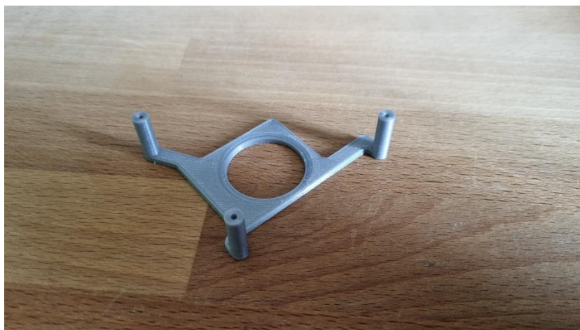
Obrázek 24: 3D tištěná konstrukce pro uchycení ventilátoru
