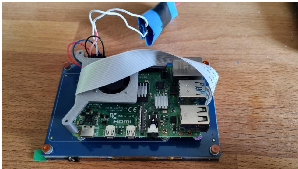
Obrázek 32: Raspberry Pi se zapojeným displejem pomocí 15pin flex kabelu
