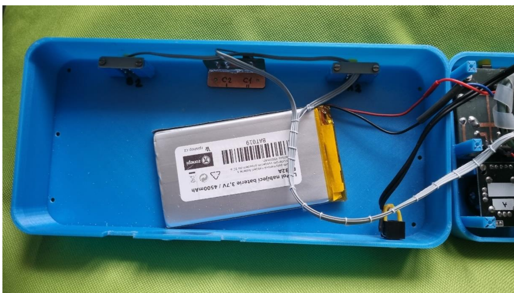
Obrázek 35: Finální zapojení zadní strany konzole
