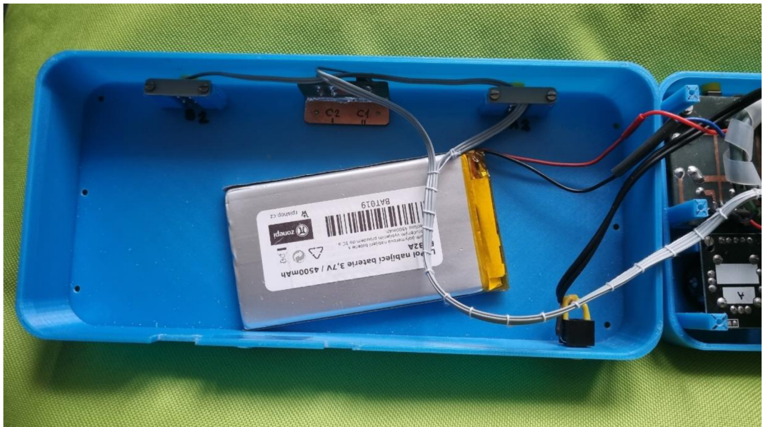
Obrázek 35: Finální zapojení zadní strany konzole
