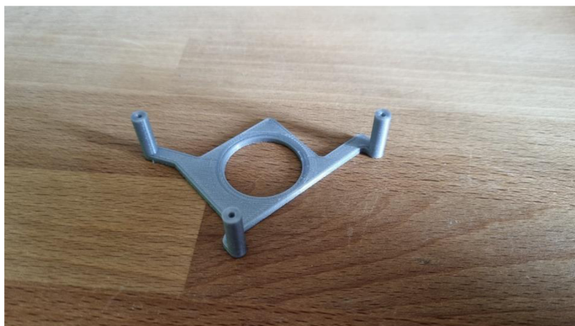
Obrázek 24: 3D tištěná konstrukce pro uchycení ventilátoru
