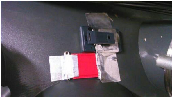
Obrázek 12: Umístění dozimetrů na interakční komoře (komora 1 nahoře: ED4, FD 2). Zdroj: Vlastní výzkum
