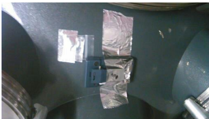
Obrázek 16: Umístění dozimetřů (Zadní část komory vpravo: ED 10, TLD 4). Zdroj: Vlastní výzkum
