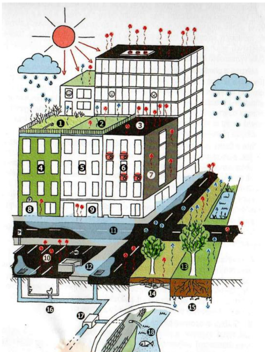
Obr. 1 Působení různých povrchů na klimatické podmínky města; 1 – Modrozelená střecha, 2 – Extenzivní zelená střecha, 3 – Konvenční střecha, 4 – Zelená fasáda, 5 – Světlá fasáda, 6 – Klimatizační zařízení, 7 – Tmavá fasáda, 8 – Sklep, podzemní garáže, 9 – Bezbariérový vstup, 10 – Uliční prostor, 11 – Záplavy ve městě, 12 – Infrastruktura, 13 – Zelené plochy, 14 – Nezavlažované plochy zeleně s omezeným vsakováním a nižším výparem, 15 – Městská zeleň na rostlém povrchu, 16 – Jednotná kanalizace, 17 – Dešťový oddělovač jednotné kanalizace, 18 – Přetok jednotné (smíšené) kanalizace Převzato z: Kopp et al. (2017)
