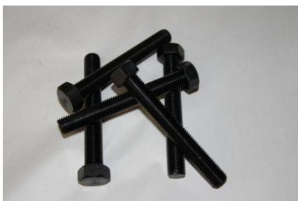
Obr. 31 Černění oceli v praxi ( http://galvanika.cz )
