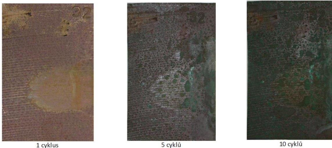
Obr. 33 Ukázka zkoušky v prostředí SO 2 (Ostrá, 2011)
