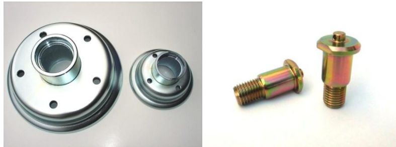
Obr. 24 Ukázka zinkových povlaků ( http://rosma.cz )
