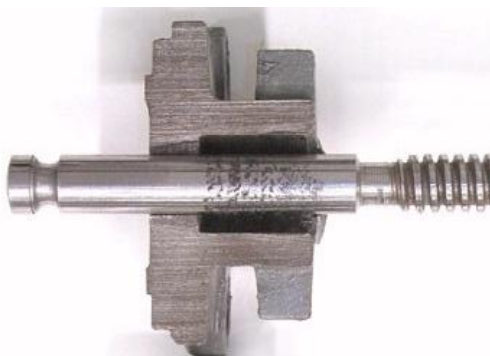
Obr. 10 Štěrbinová koroze vřetena uzavíracího ventilu ( http://vscht.cz )
