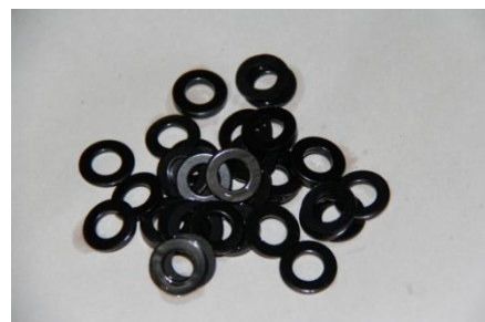
Obr. 31 Černění oceli v praxi ( http://galvanika.cz )
