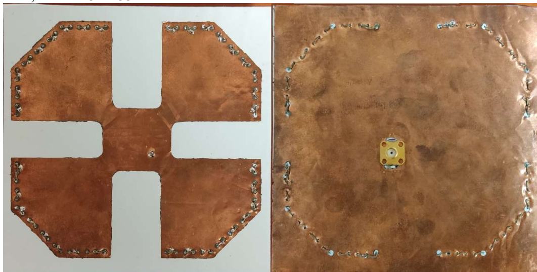
Obr. 32 Výrobek antény (a) pohled shora, (b) pohled zespodu
