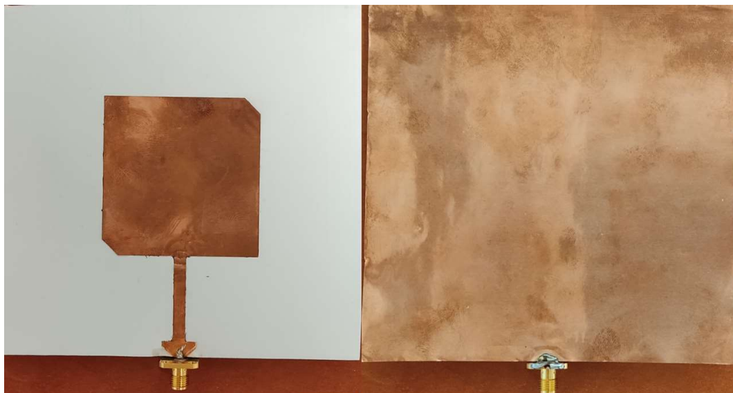
Obr. 33 Výrobek flíčkové antény (a) pohled shora, (b) pohled zespodu
