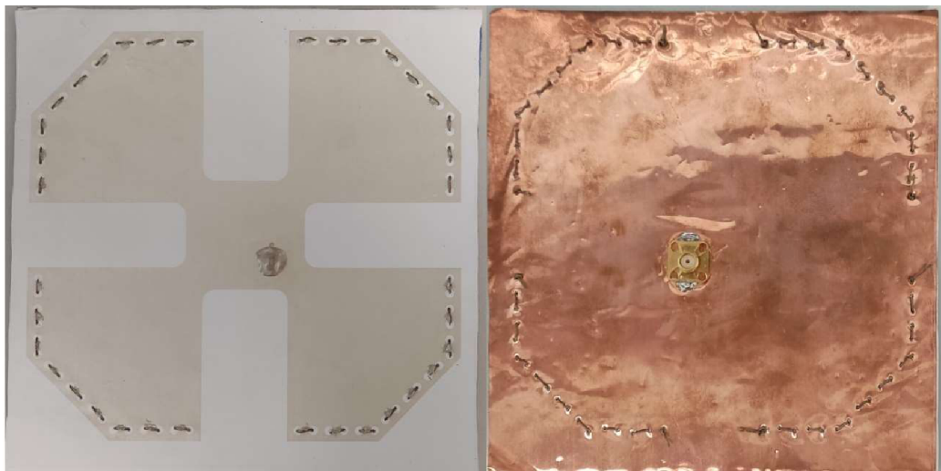
Obr. 35 Výrobek antény (a) pohled shora, (b) pohled zespodu
