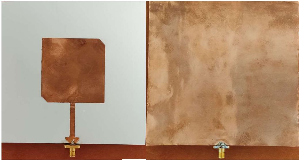
Obr. 33 Výrobek flíčkové antény (a) pohled shora, (b) pohled zespodu
