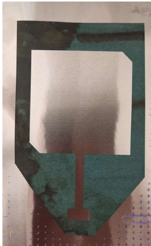
Obr. 30 Vyleptaná fličková anténa s ořezanými hranami
