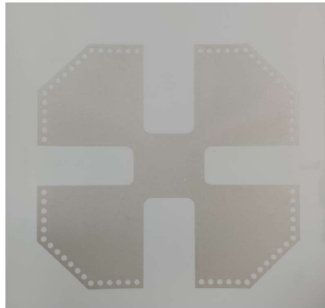
Obr. 34 Vyrobená planární anténa sítotiskem
