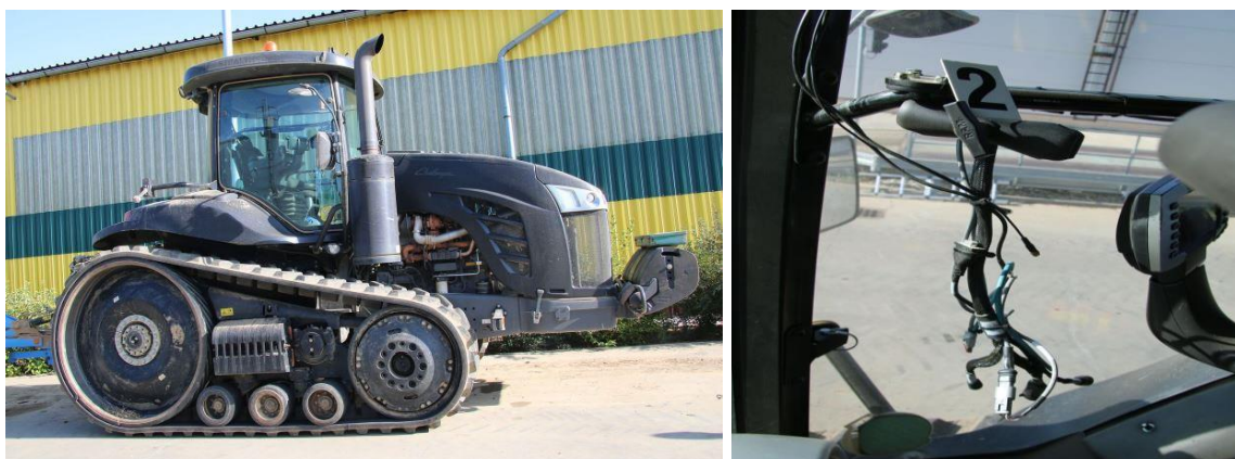
Obrázek 20. Pásový traktor Challenger – místo demontáže kabinové GPS sestavy. Zdroj: vlastní
