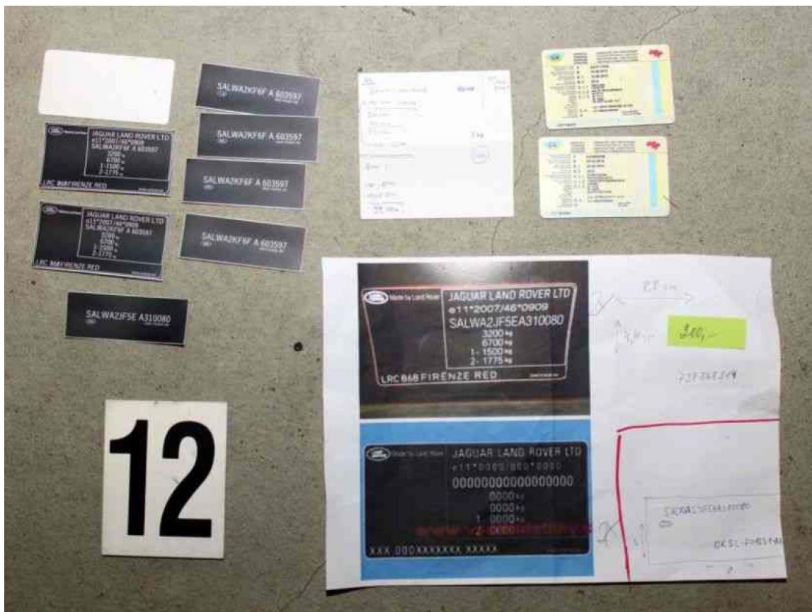
Obrázek 13. Legalizace vozidla Range rover – padělání typových štítků. Zdroj: vlastní
