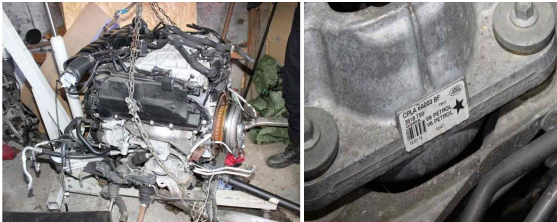
Obrázek 16. Legalizace – Motor Land rover a vyhledaný štítek s PKN kódem. Zdroj: vlastní
