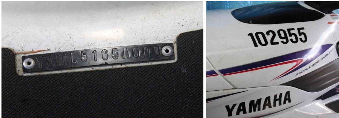
Obrázek 25. Identifikátory vodního skútru – číslo skeletu a vnější plavební značení. Zdroj: vlastní
