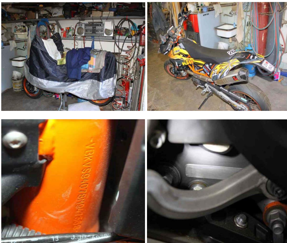
Obrázek 22. Nález motocyklu KTM – zjištění zásahu do identifikátorů motoru a VIN. Zdroj: vlastní
