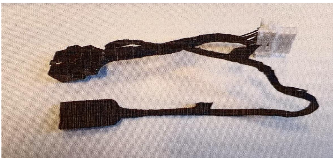
Obrázek 9. Upravený kabel propojení řídicí jednotky motoru a OBD konektoru. Zdroj: vlastní
