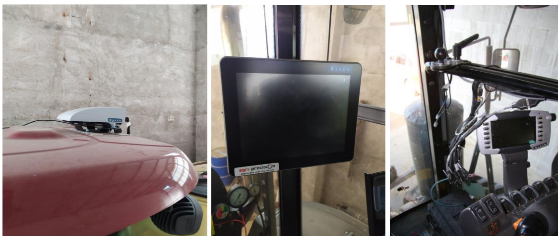
Obrázek 21. Jednotlivé díly vnější a kabinové GPS sestavy. Zdroj: vlastní
