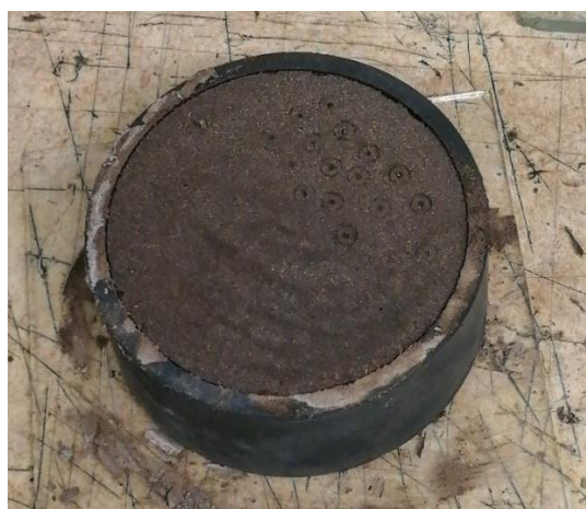
Obr. 5: Ukázka měření konce tuhnutí
