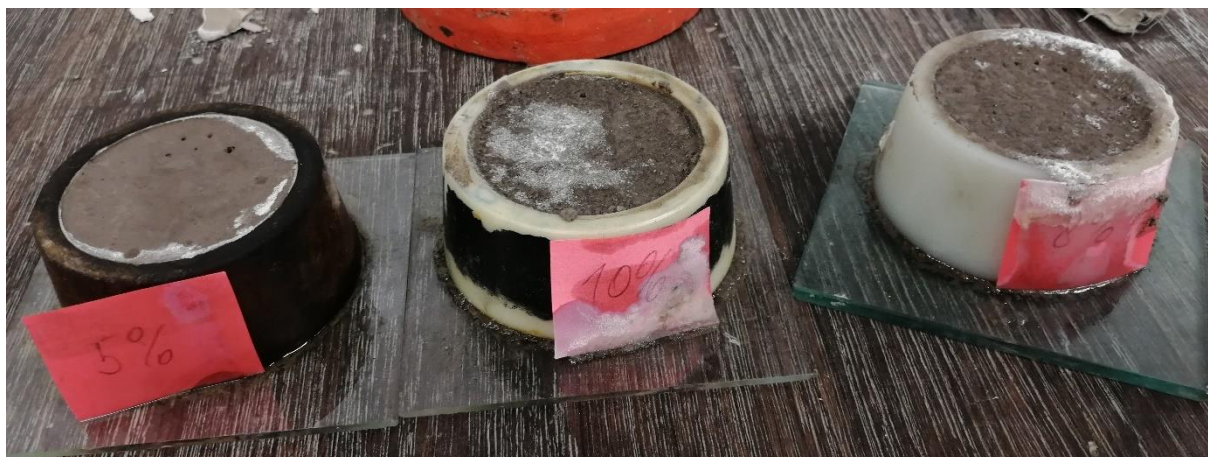
Obr. 7: Ukázka alkalického výkvětu na vzorcích obsahující síran sodný
