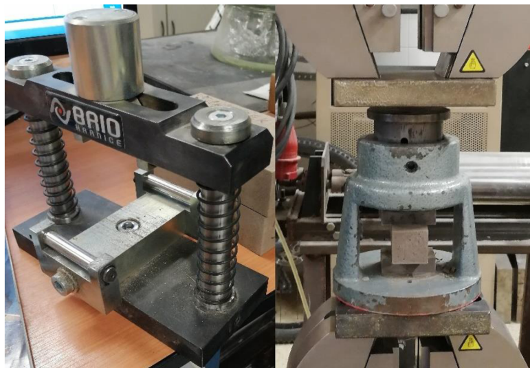
Obr. 6: Zařízení pro měření pevností v ohybu (vlevo) a pevností v tlaku (vpravo)
