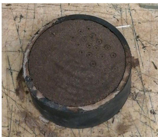
Obr. 5: Ukázka měření konce tuhnutí
