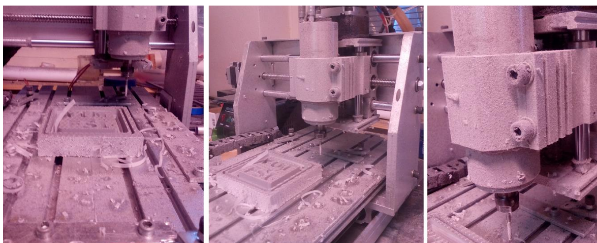
Obr. 5.6 Obrobení polystyrenu bez použití odsávání a se změnou rezných podmínek
