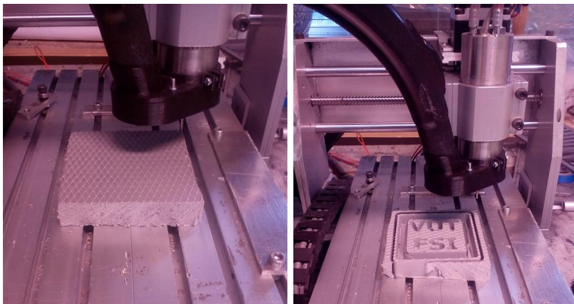
Obr. 5.4 Obrobení polystyrenu s použitím odsávání
