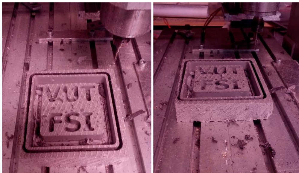
Obr. 5.5 Obrobení polystyrenu bez použití odsávání
