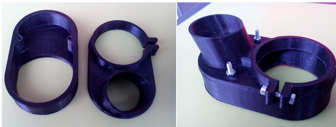
Obr. 5.2 Vytisknuté díly a jejich sestavení
