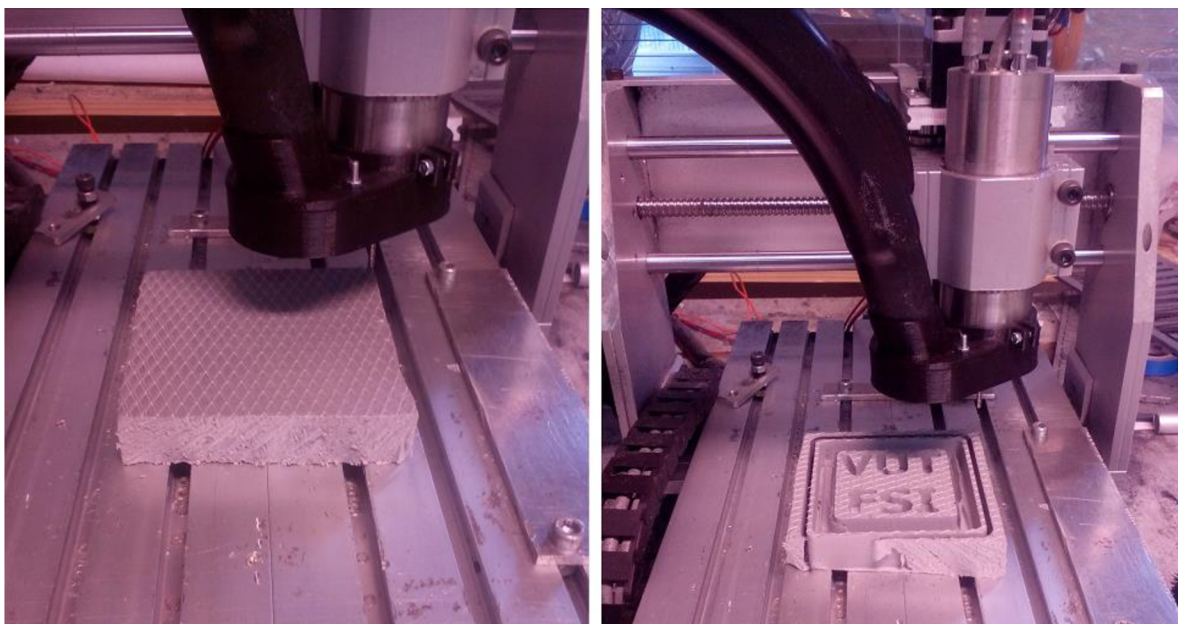
Obr. 5.4 Obrobení polystyrenu s použitím odsávání
