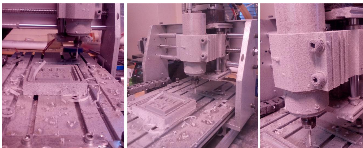
Obr. 5.6 Obrobení polystyrenu bez použití odsávání a se změnou řezných podmínek
