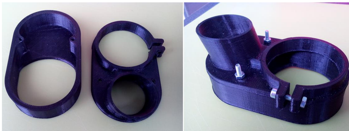
Obr. 5.2 Vytisknuté díly a jejich sestavení
