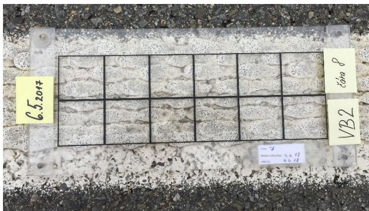
Vzorek VB2 s termoplastem – po 12 měsících – odlupek značení na levé straně – čára č. 9
