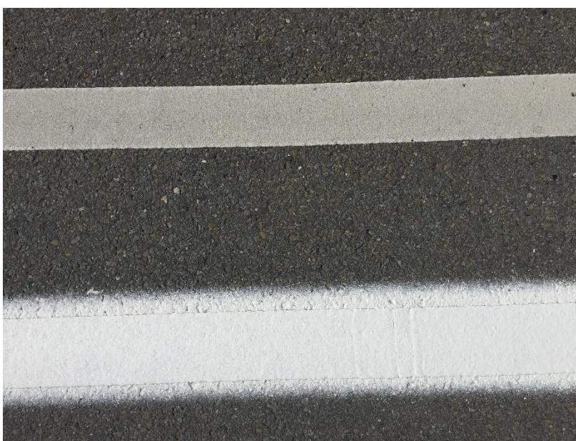
Obrázek č. 36: Vzorek KP 1116 – porovnání původního stavu a obnovy
