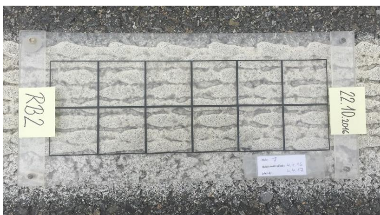
Vzorek RB2 s termoplastem – po 12 měsících – značné odlupky vyskytující se v téměř celé délce čáry – čára č. 7
