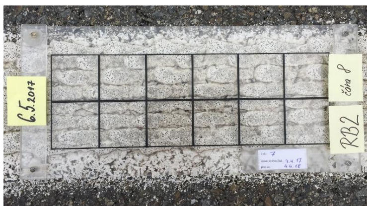
Vzorek RB2 s termoplastem – po 12 měsících – čára č. 9
