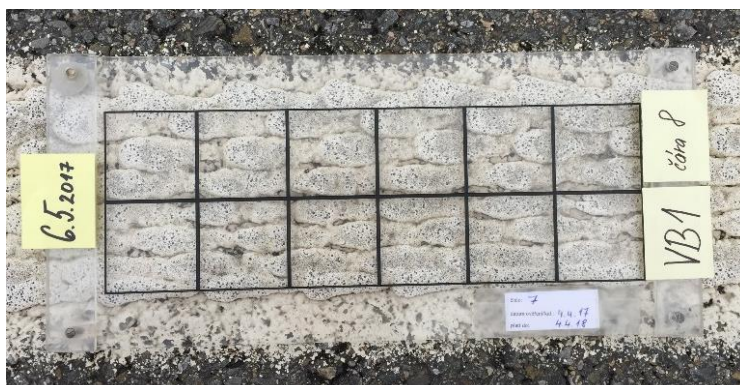
Vzorek VB1 s termoplastem - po 12 měsících – čára č. 8
