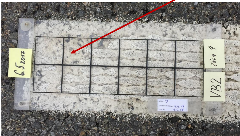
Vzorek VB2 s termoplastem – po 12 měsících – odlupek značení na levé straně – čára č. 9
