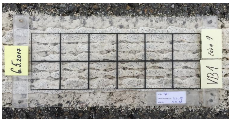
Vzorek VB1 s termoplastem - po 12 měsících – čára č. 8
