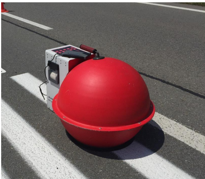
Obrázek č. 10: Retroreflektometr QD 30
