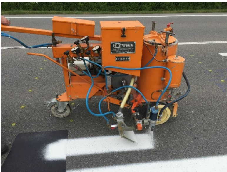
Obrázek č. 24: Vzorek RB2 a stroj pro pokládku Hofmann H8
