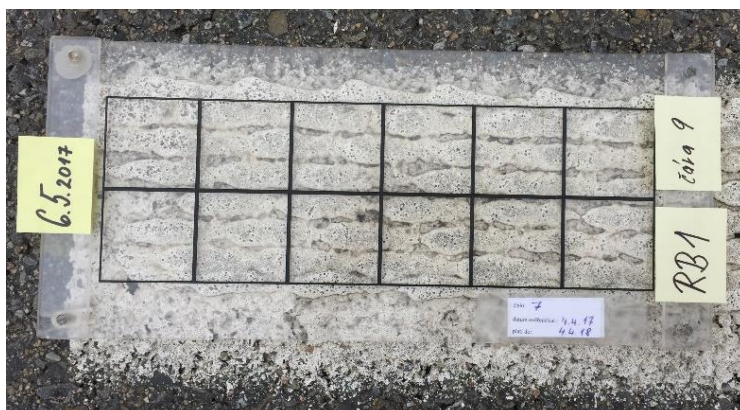
Vzorek RB1 s termoplastem – po 12 měsících – čára č. 9
