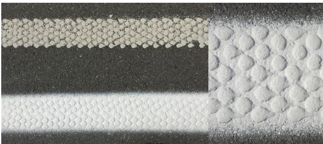
Obrázek č. 32: Vzorek TPS 1006 – porovnání původního stavu a obnovy
