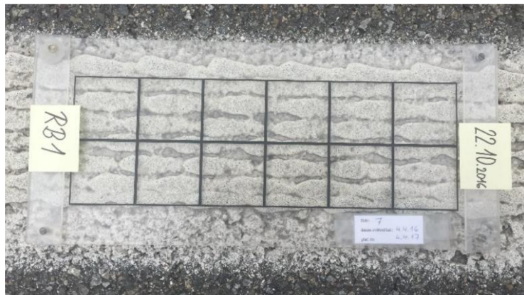
Vzorek RB1 s termoplastem – po 12 měsících - odlupek značení na levé straně – čára č. 7
