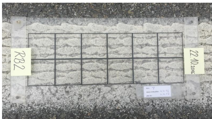
Vzorek RB2 s termoplastem – po 12 měsících – značné odlupky vyskytující se v téměř celé délce čáry – čára č. 7
