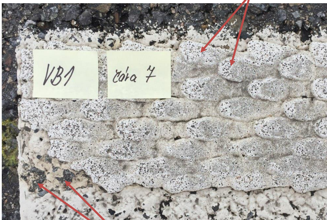
Obrázek č. 38: Vzorek VB1 s termoplastem – čára č. 7
