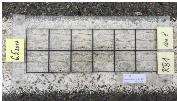
Vzorek RB1 s termoplastem – po 12 měsících – čára č. 8
