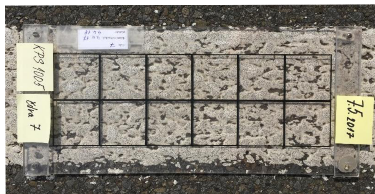
Vzorek KPS 1005 – původní – po 12 měsících
