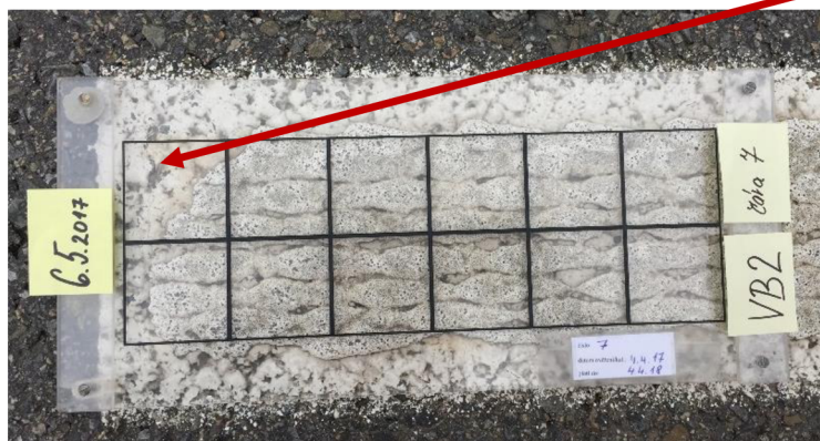
Vzorek VB2 s termoplastem – po 12 měsících – čára č. 8
