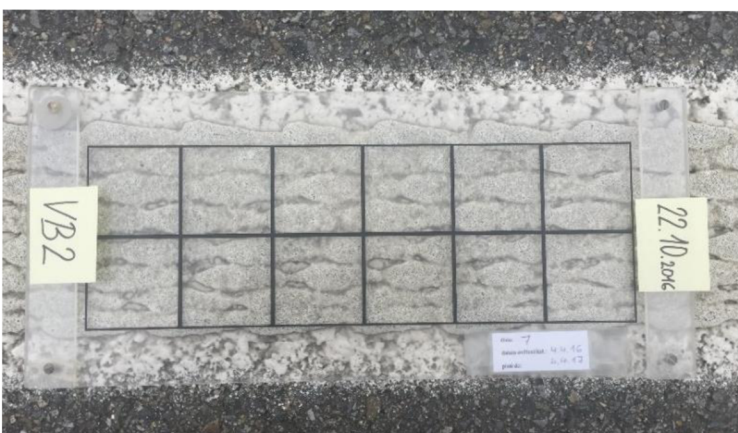
Vzorek VB2 s termoplastem – po 5 měsících
