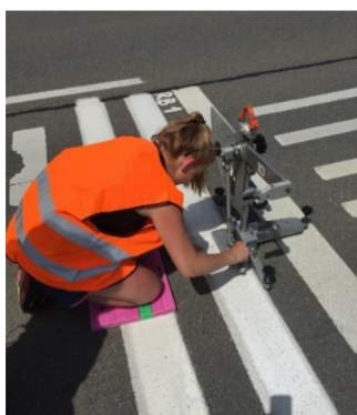
Obrázek č. 14: Měření kyvadlovým přístrojem TRRL
