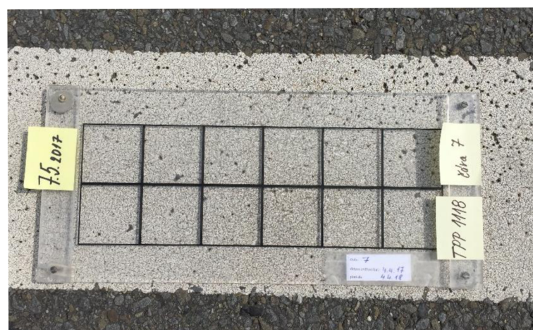
Vzorek TPP 1118 – původní – po 12 měsících
