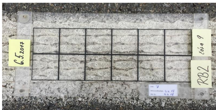
Vzorek RB2 s termoplastem – po 12 měsících – čára č. 9
