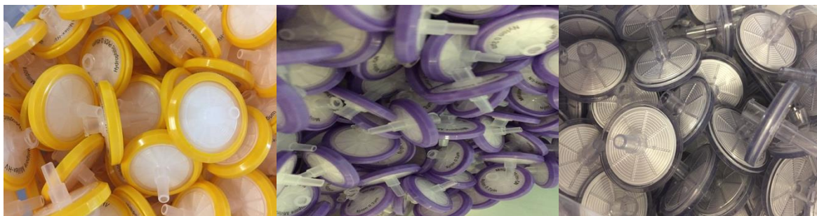
Obrázek č. 54. Filtry pro mikropolutanty (vlevo), analýzy amoniaku, dusitanů a dusičnanů (uprostřed) a pro TOC a TN (vpravo).
