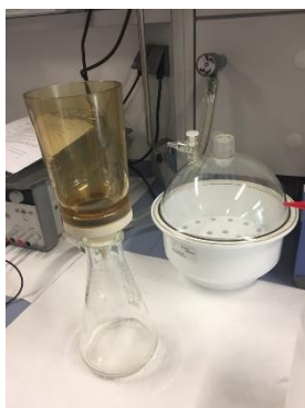
Obrázek č. 55. Zařízení pro vakuovou filtraci
