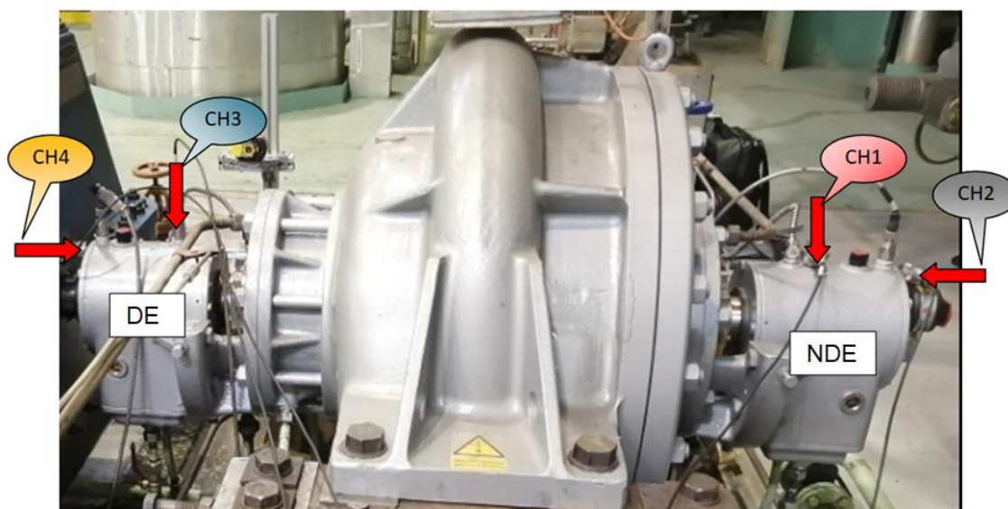
Obr. 87) Osazení čidel vibrací na čerpadle
