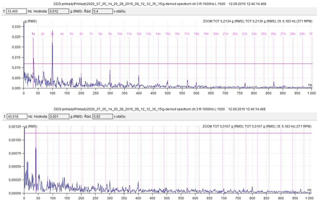
Obr. 19) Spektrum obálky zrychlení s filtrem 0,5 a 5 kHz
