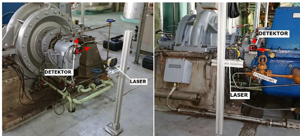
Obr. 95) Měření polohy osy (LiveTime metoda) při oteplování čerpadla
