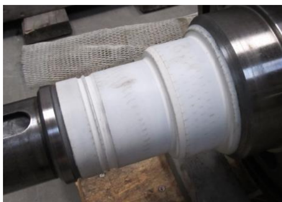
Obr. 73) Izolovaný nástřík hřídele
