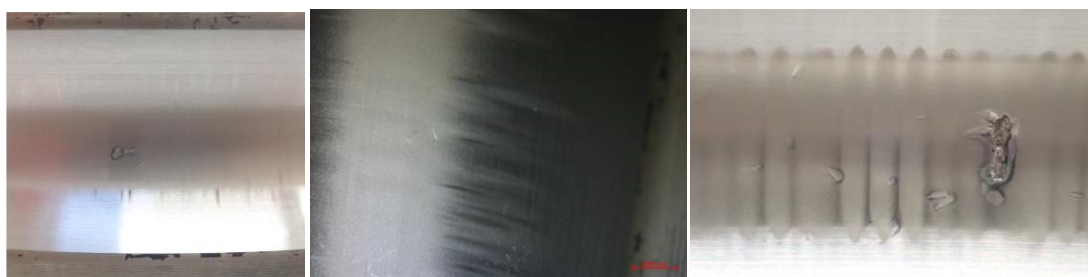
Obr. 82) Snímky poškození ložiska
