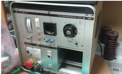
Obr. E.1: Oddělovací transformátor
