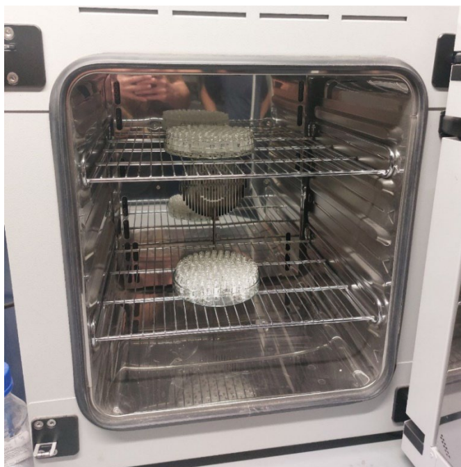
Obr. 4: Sušící trouba se vzorky
