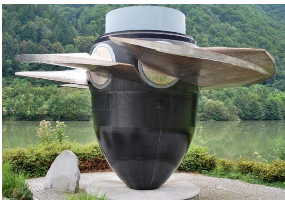
Obrázek 4.13: Rotor přetlakové Kaplanovy turbíny [6]
