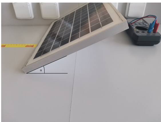
Obrázek 6.12: Zapojení panelu a měření úhlu naklonění panelu vzhledem ke zdroji [foto autora]
