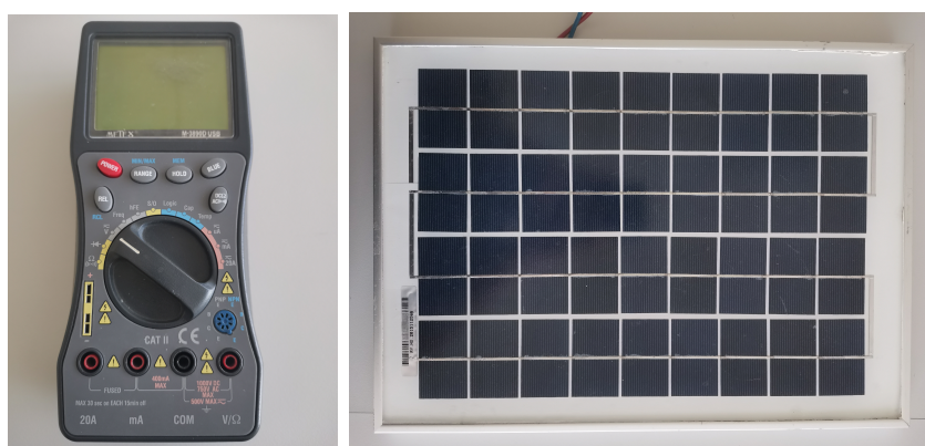
Obrázek 6.10: Multimetr METEX M 3890D a solární panel využitý pro měření [foto autora]
