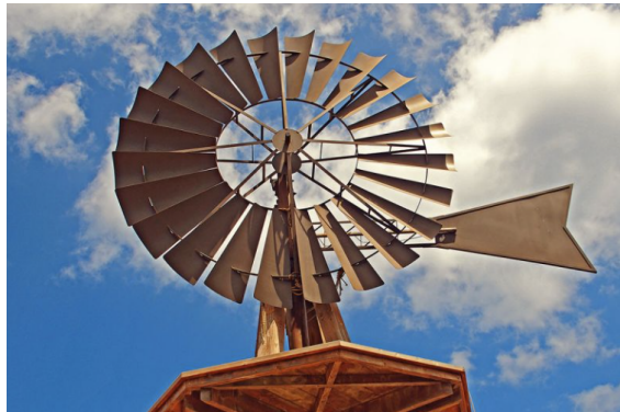
Obrázek 2.7: Mnoholistý odporový větrný mlýn používaný k čerpání vody především ve Spojených Státech, jižní Africe a v Austrálii [6]
