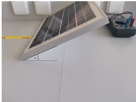
Obrázek 6.12: Zapojení panelu a měření úhlu naklonění panelu vzhledem ke zdroji [foto autora]
