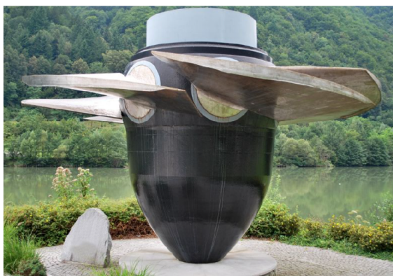
Obrázek 4.13: Rotor přetlakové Kaplanovy turbíny [6]
