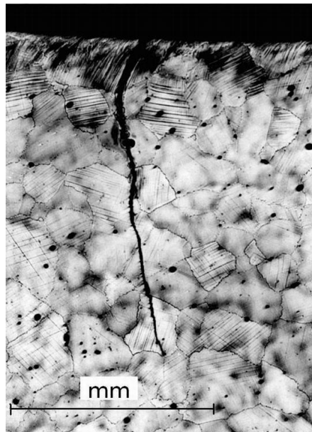
Obr. 2.2.1.2 – Vzniklá magistrální trhlina [10]
