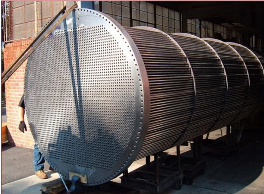
Obr. 2.1.1.2 – Trubkový svazek výměníku typu Shell and tube
