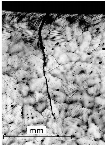
Obr. 2.2.1.2 – Vzniklá magistrální trhlina [10]
