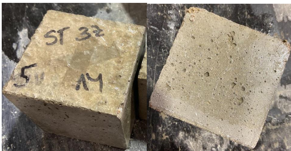
Obr. 25 – Detail povrchu zkušebního tělesa po cyklování teplotní slučitelnosti RECEPTURA 3
