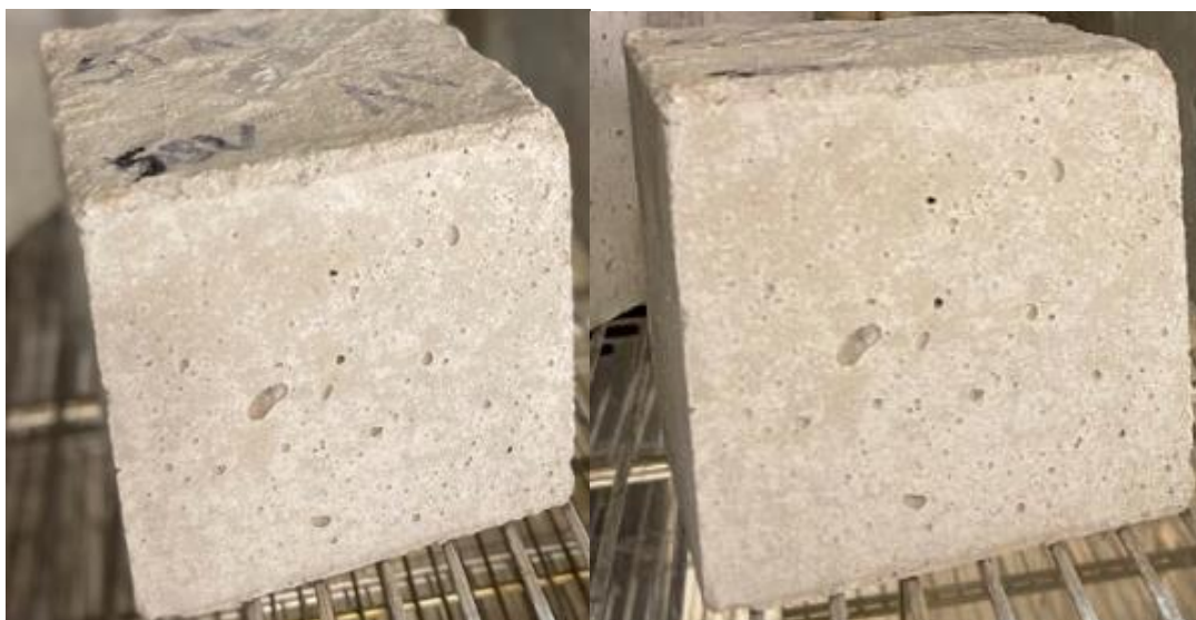
Obr. 27 - Detail povrchu zkušebního tělesa po cyklování sušárna+voda RECEPTURA 1
