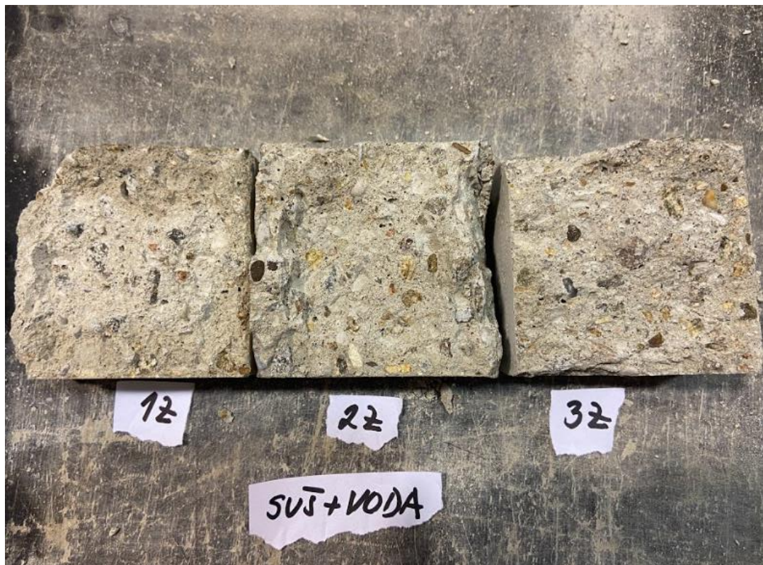
Obr. 26 - Struktura betonu po 50 cyklech sušárny + vody
