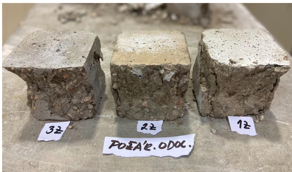
Obr. 20 - Zkušební kostky po pevnosti v tlaku, vnitřní struktura
