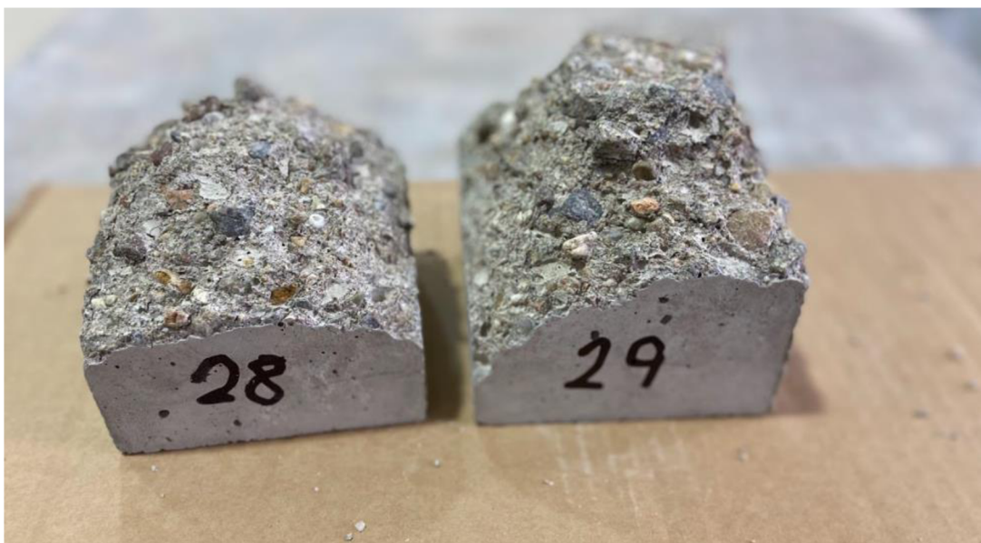
Obr. 17 - Zkušební vzorky po zkoušce CHRL – RECEPTURA 2
