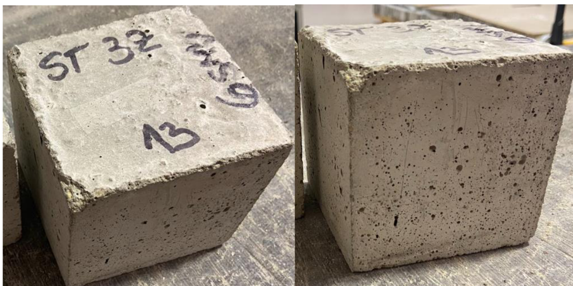
Obr. 30 - Detail povrchu zkušebního tělesa po cyklování suchý mráz+sušárna RECEPTURA 3
