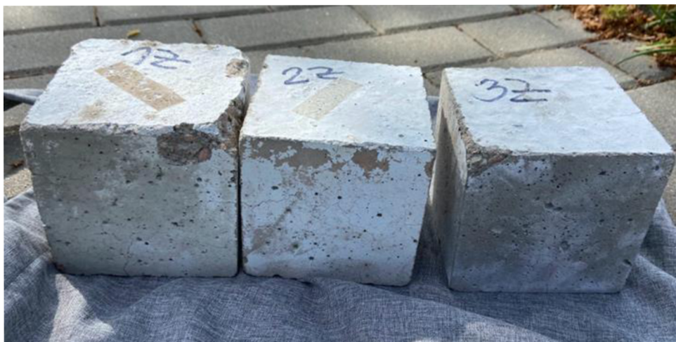
Obr. 19 – Zkušební vzorky po výpalu
