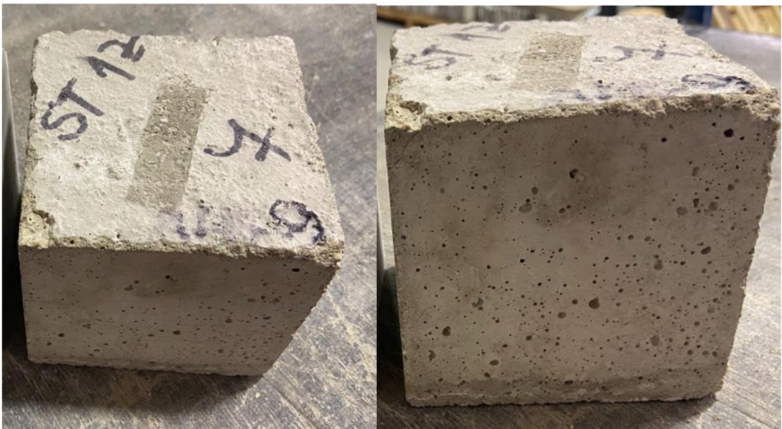
Obr. 29 - Detail povrchu zkušebního tělesa po cyklování suchý mráz+sušárna RECEPTURA 1
