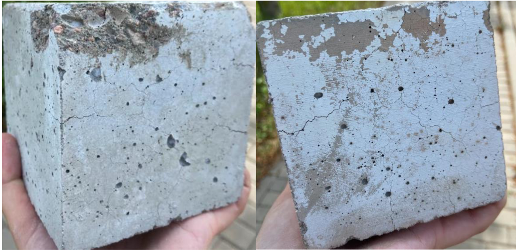
Obr. 21 – Detail porušení (RECEPTURA 1 vlevo a RECEPTURA 2 vpravo)
