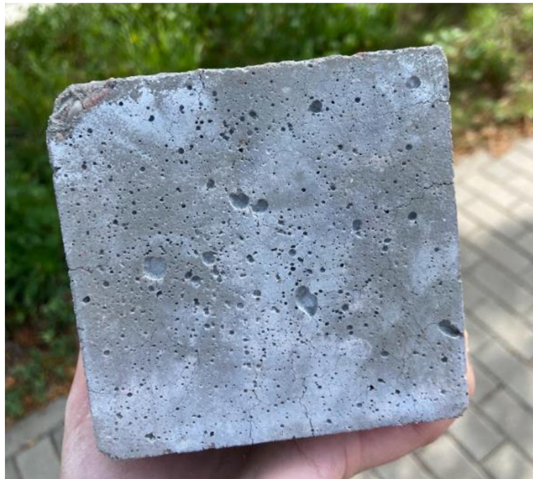
Obr. 22 - Detail porušení RECEPTURY 3
