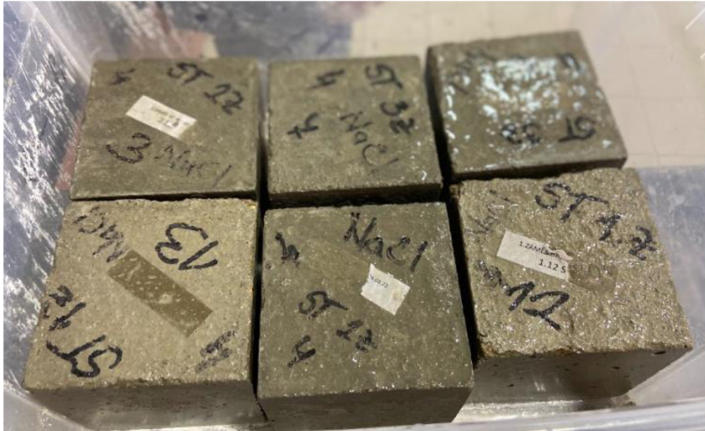
Obr. 24 – Zkušební vzorky po cyklování teplotní slučitelnosti
