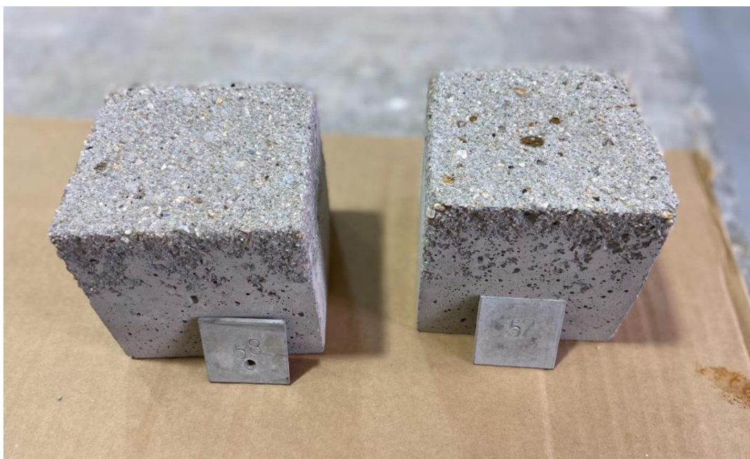
Obr. 18 - Zkušební vzorky po zkoušce CHRL – RECEPTURA 3
