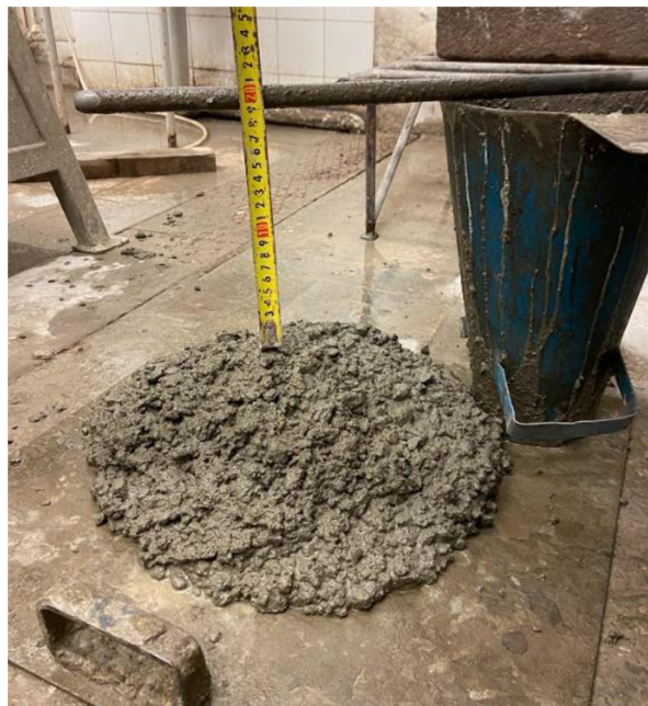
Obr. 10 – Zkouška sednutí kužele
