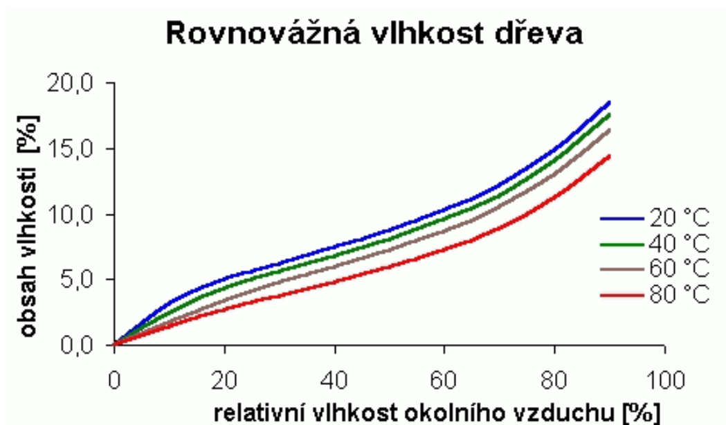
Obrázek 14: Rovnovážná vlhkost dřeva v závislosti na teplotě a vlhkosti okolního vzduchu (Zdroj: http://www.tzb-info.cz/docu/clanky/0015/001535o2 )
